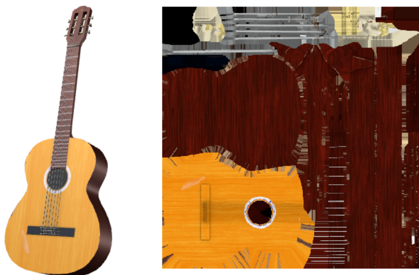
Slika 3.8: Primjer korištenja teksture. Tekstura modela prikazana je u trodimenzionalnom prostoru (lijevo) i u prostoru teksture (desno).
