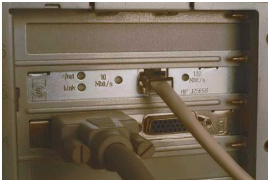
Slika 8.10: poleđina računala s mrežnom karticom i TP kablom za spoj na TP Ethernet.
