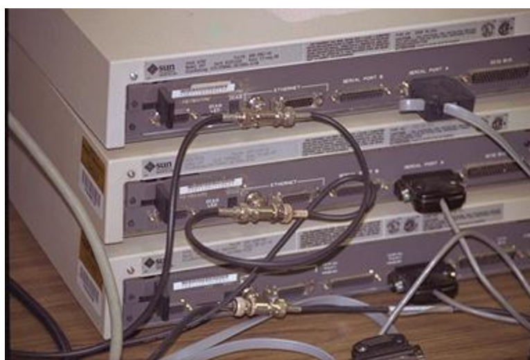
Slika 8.8: tri računala povezana BNC konektorima na Thin Ethernet.
